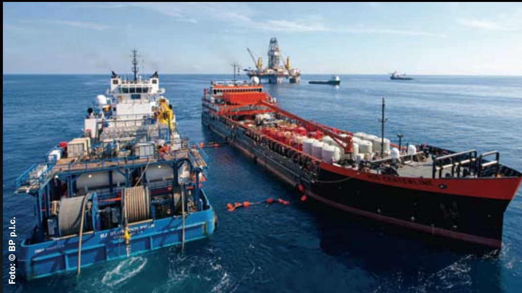
Los buques Blue Dolphin y HOS Centerline bombean lodo para sellar la fuga en el Golfo de México, 3 de agosto, 2010.
