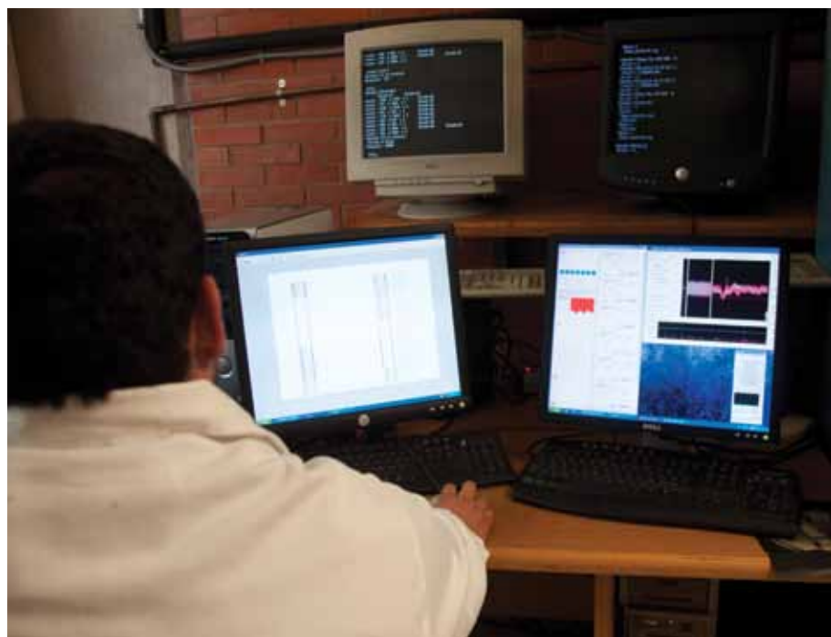
A través de programas diseñados en el laboratorio se determina cómo la actividad eléctrica neuronal (potencial de acción) cambia cuando el mono realiza una tarea de discriminación (izq.), al mismo tiempo que se controla el desplazamiento de los microelectrodos dentro la corteza cerebral y se determinan las propiedades (amplitud y duración) de esta actividad (der.).
