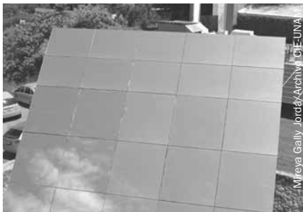
Heliostato, CIE-UNAM (9 x 9 m).
