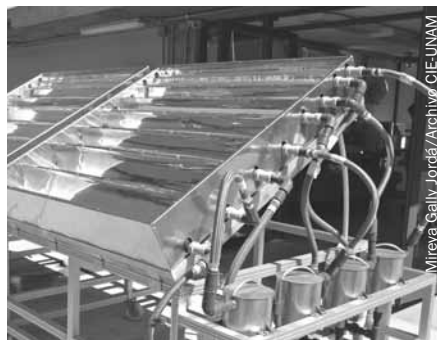
Planta solar para el tratamiento de aguas residuales.
