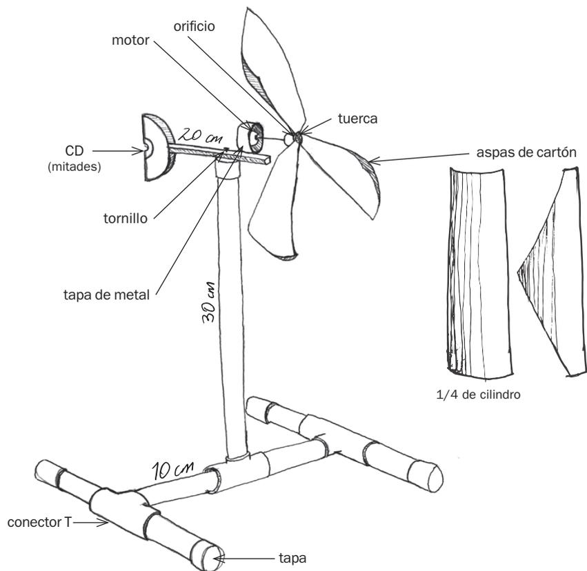
5. Ensamble: Justo detrás del motor perfora un agujero que utilizarás para ensamblar la base del motor (con la veleta) y el poste; usa un tornillo delgado para que pueda girar libremente.
